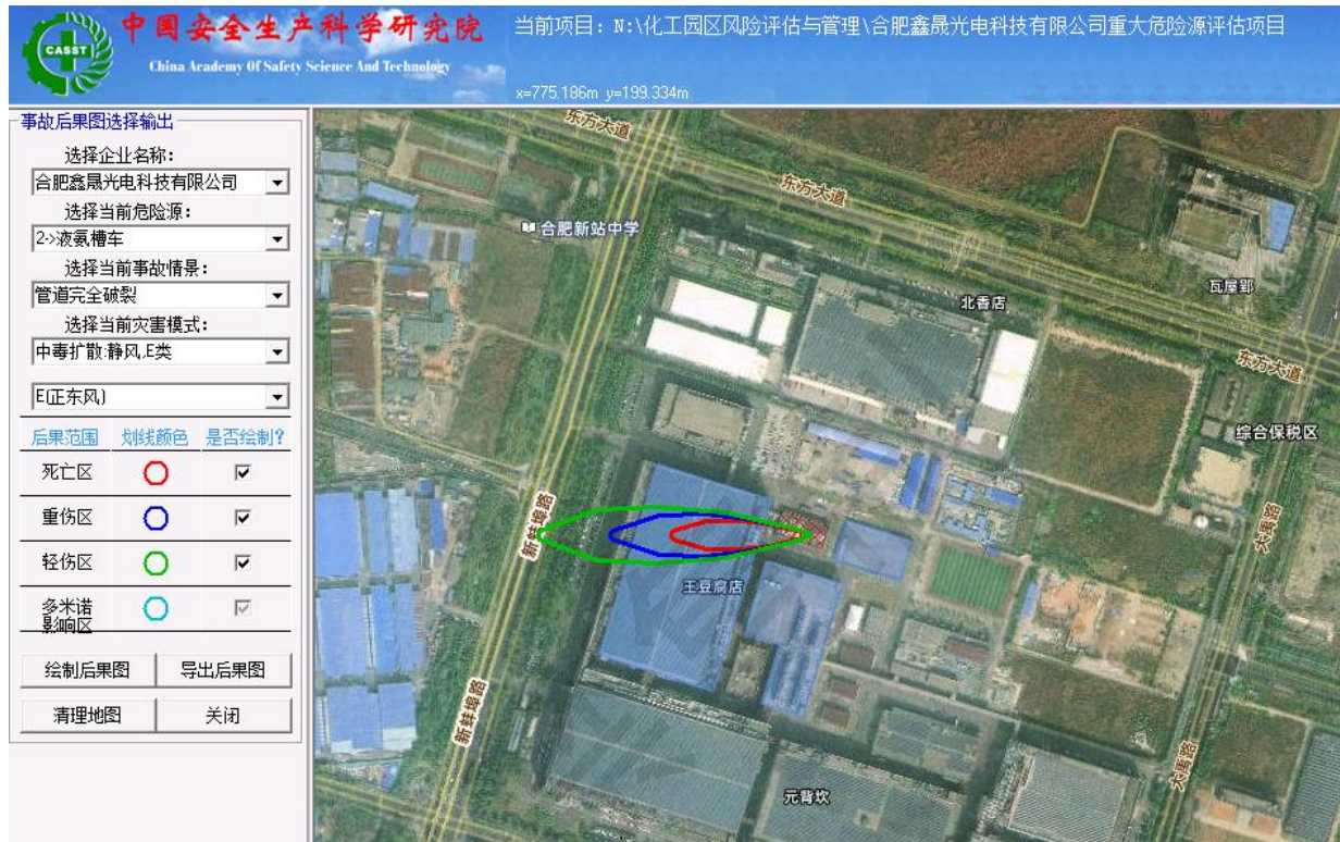
图 5-4 7#特气车间液氨槽车破裂中毒扩散事故模拟结果图
