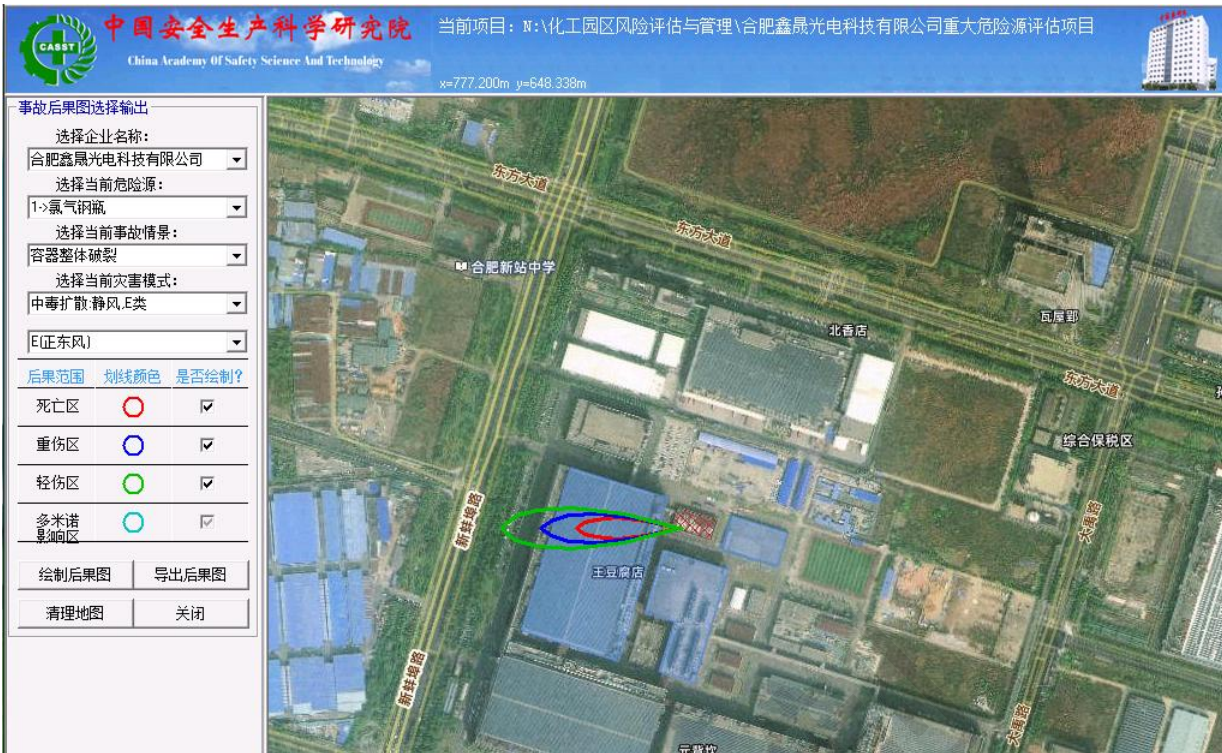
图 5-2 7#特气车间液氯钢瓶破裂中毒扩散事故模拟结果图
