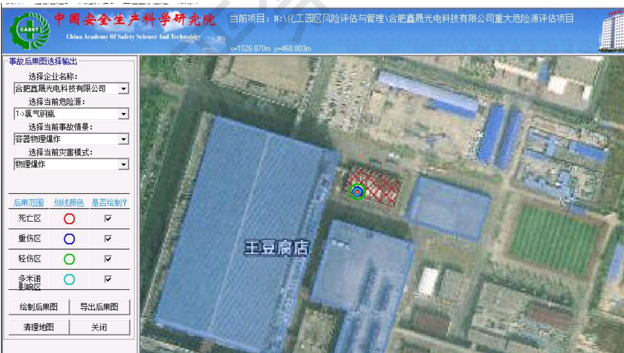
图 5-3 7#特气车间液氯钢瓶物理爆炸事故模拟结果图
