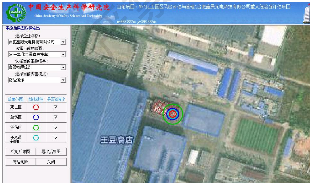
图 5-6 7#特气车间一氧化二氮管束拖车物理爆炸事故模拟结果图
