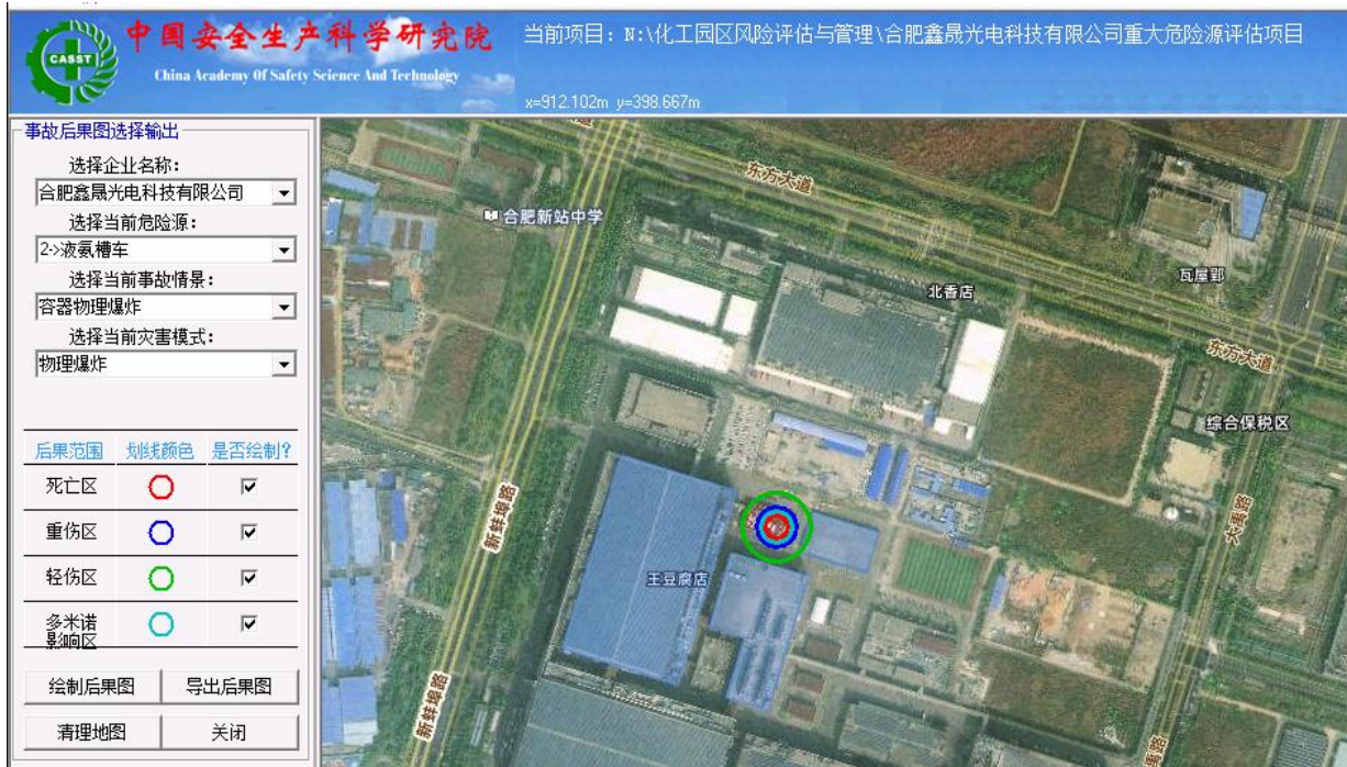
图 5-5 7#特气车间液氨槽车物理爆炸事故模拟结果图
